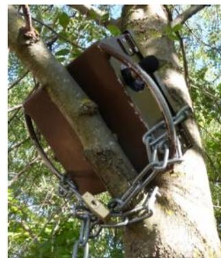
Enregistreur automatisé de type SM2 installé sur l'aire d'étude - Photo in situ
